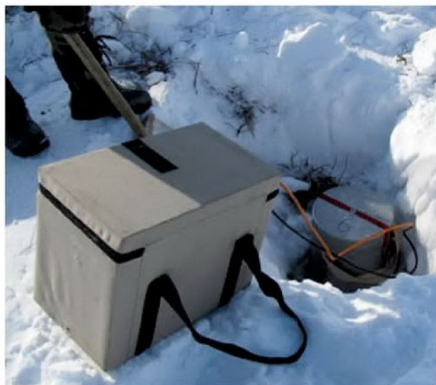
Установка регистрирующего комплекса в условиях низких температур
