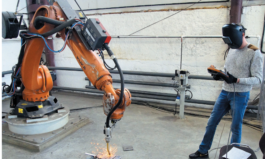
Автоматическая сварка деталей промышленным роботом KUKA в цехе металлоконструкций
